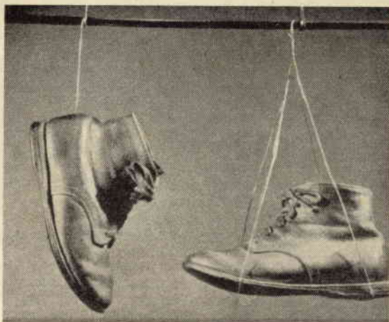
Due metodi, altrettanto buoni, per sospendere l'oggetto alla bacchetta che è collegata al polo negativo. Naturalmente, il filo a cui l'oggetto è sospeso deve essere di rame.
